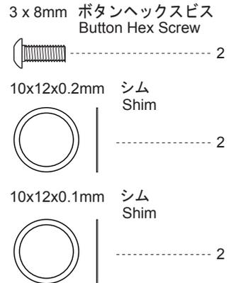
**A** ギヤボックスに取付時、バックラッシュがゆるい場合、反対側のシムと入れ替える。
